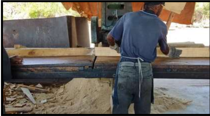
Figura 18: Proceso de la madera por la maquina despuntadora
