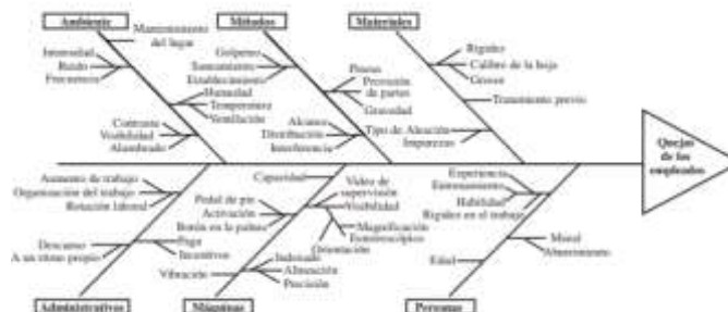
Figura 8: Diagrama de pescado que se utiliza para identificar las quejas de salud de los trabajadores Fuente: Niebel B y Freivalds A (2009)
