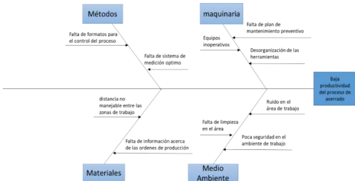
Figura 23: Diagrama de Ishikawa de las principales causas de la baja productividad del proceso
