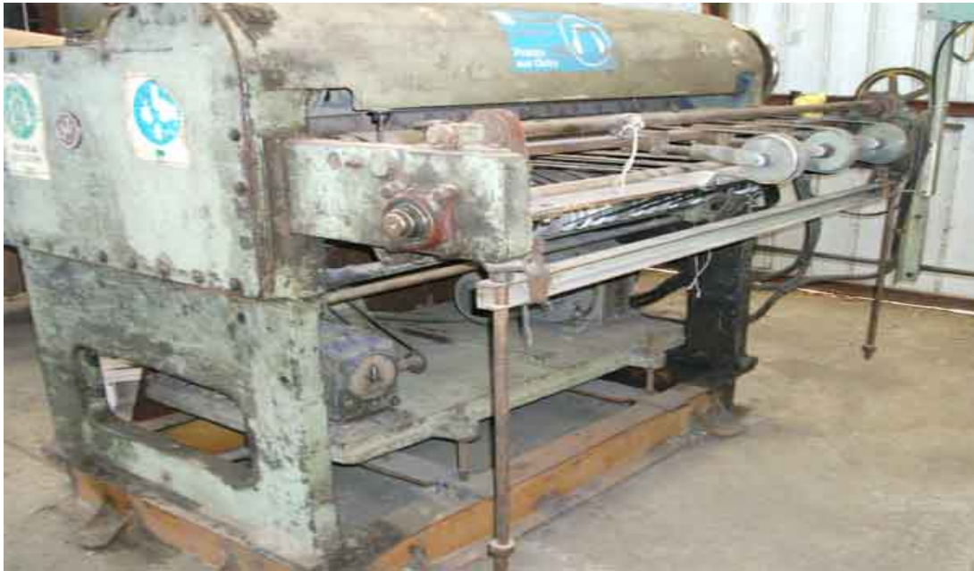
Figura 7. Condiciones inadecuadas de las maquinarias (Equipo de Corte) Fuente: Origami, C.A. (2017).
