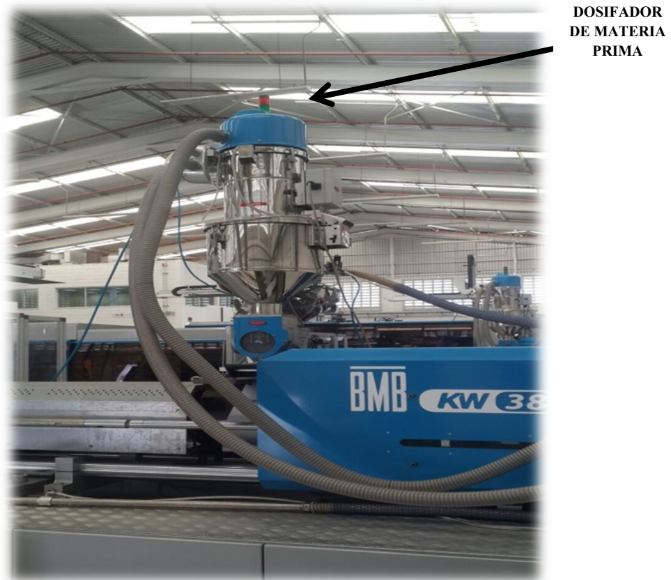
Figura 7: Dosificador y tolva de una máquinas de inyección de ENVACA, C.A.
