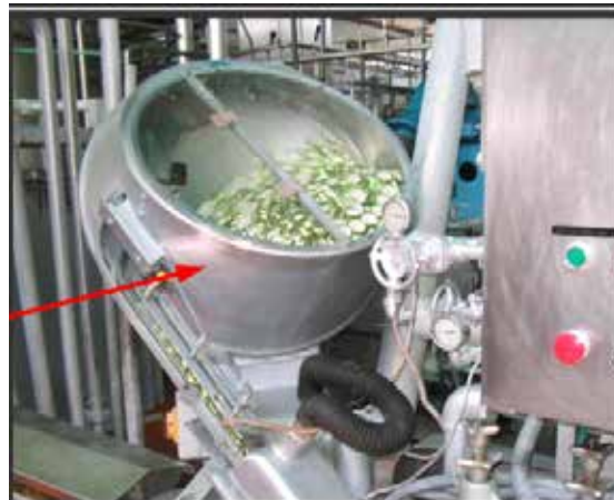
Figura 20 Tolva y Bajante de la tapadora Autor: Ocanto A. (2017)
