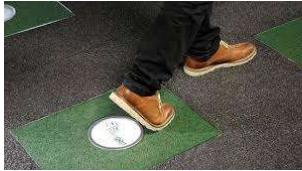
Figura 25. Pisos de láminas piezoeléctricas. Fuente: http://www.abc.es/ciencia/20130527/abc-baldosas-inteligentes-generan-electricidad-201305271330.html (2017).
