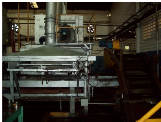
Figura 3. Sistema automático de carga de espirales al horno de revenido.
