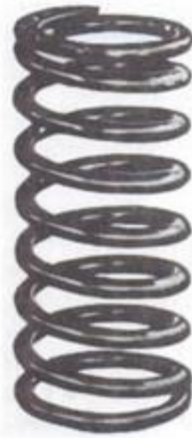
Figura 7. Muelle helicoidal utilizado en un sistema de suspensión delantera Fuente: Crouse, W. (1993).
