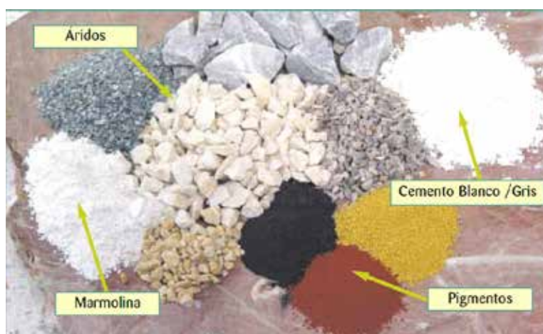
Figura 3: Materia prima utilizada en la fabricación general de una baldosa.
