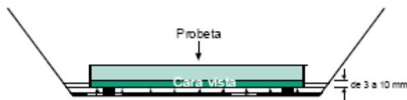
Foto: Ensayo de Absorción de agua por la cara vista.
