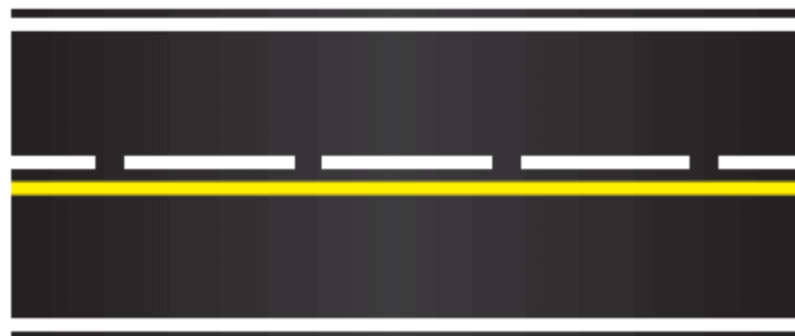
Figura 47. Demarcación “RAYA CENTRAL CONTINUA, DISCONTINUA O SENCILLA”.
