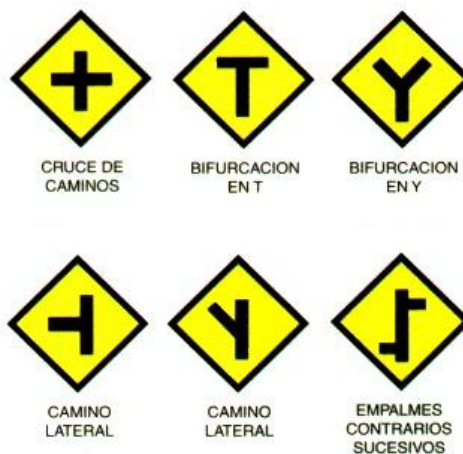
Figura 34. Señales de “PREVENCIÓN CON CRUCES”.
