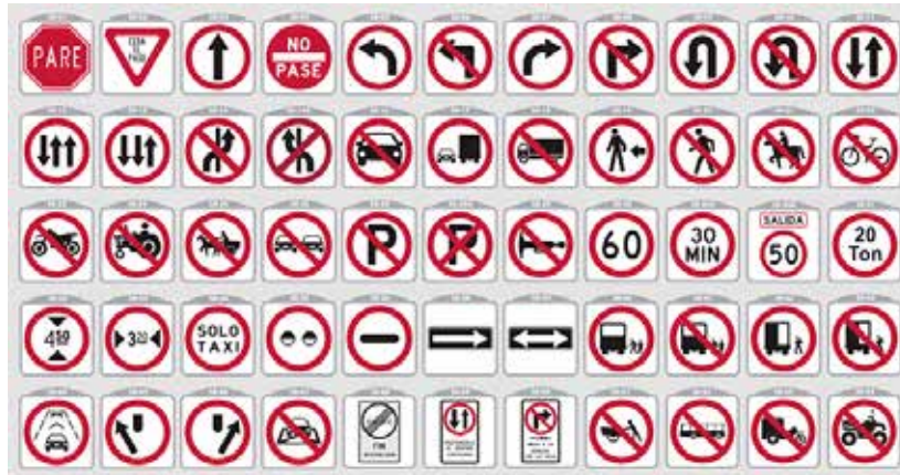
Figura 27. Señales de prohibición.
