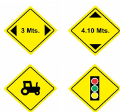
Figura 38. Señales de “PREVENCIÓN DE CARACTERÍSTICAS DE LA VÍA”.
