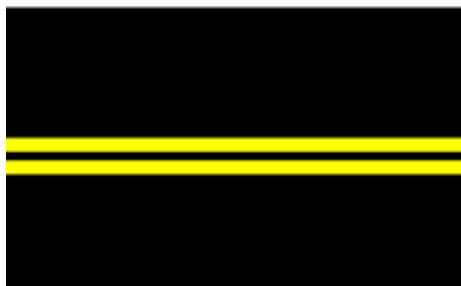
Figura 49. Demarcación “RAYA CENTRAL DOBLE CONTINUA”.
