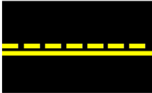
Figura 48. Demarcación “RAYA ADICIONAL CONTINUA PARA PROHIBIR EL REBASE”.
