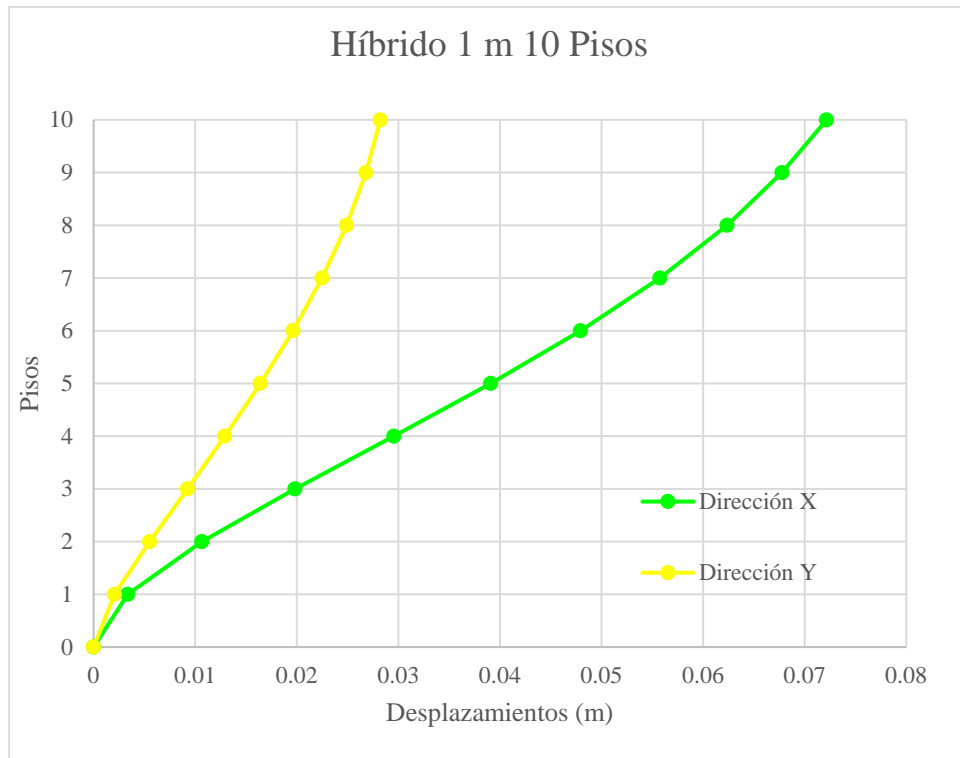
Gráfica 71. Gráfica de resultados de desplazamiento máximo híbrido de 1 m de 10 pisos.
