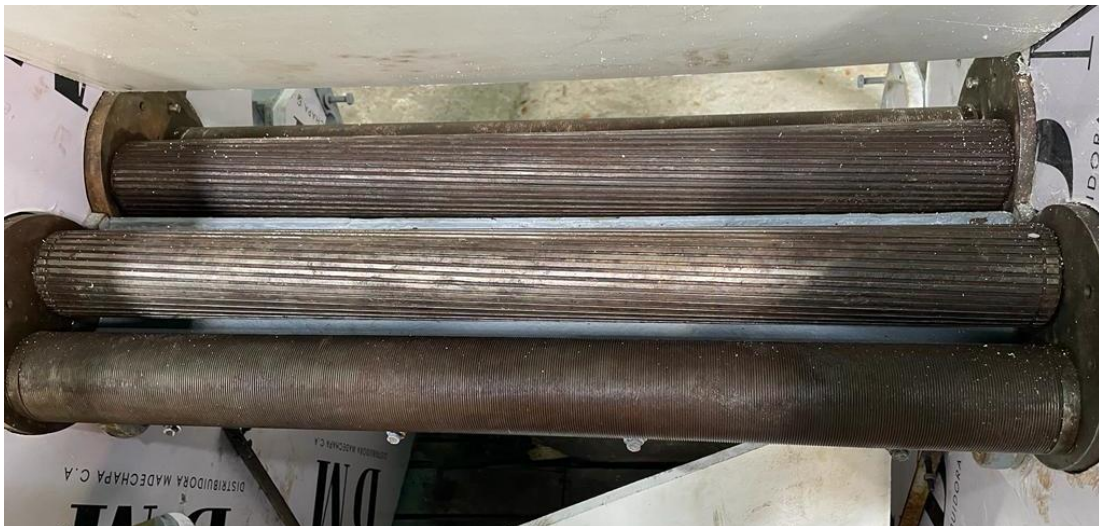
Figura 2: Rodillos Alimentadores para el Banco de Molienda. Fuente: Propia. (2021)
