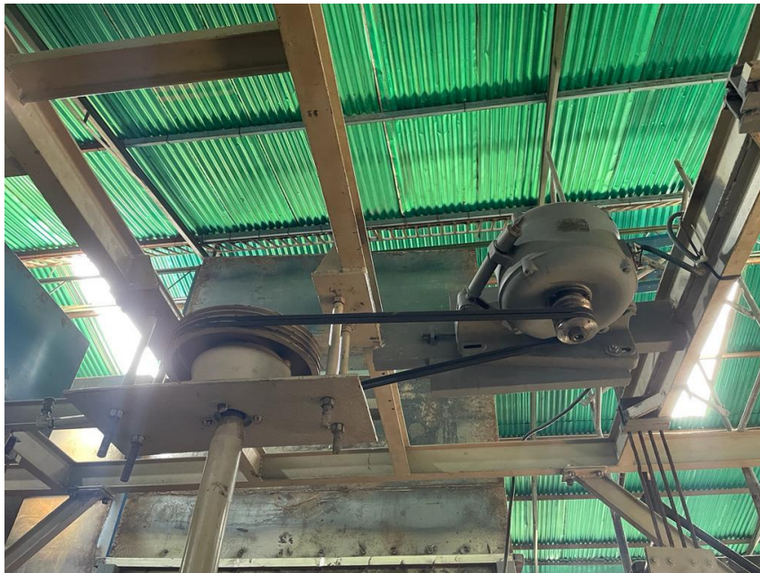
Figura 14: Polea y Motor-Reductor de Cernedor OCRIM. Fuente: Propia. (2021)
