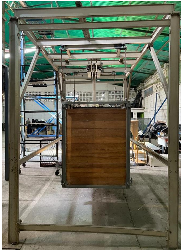
Figura 11: Vista Lateral Cernedor OCRIM y Estructura. Fuente: Propia. (2021)
