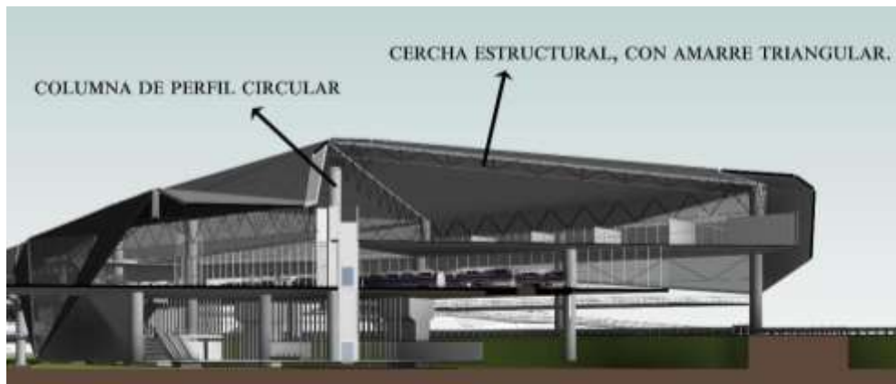
27. Figura 27. Ejemplo de vigas y columnas estructurales. El autor (2017)
