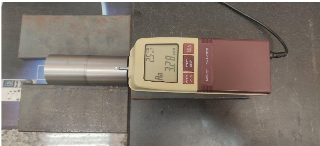
Figura 71: Vista Superior de la Segunda Configuración de Medición. Fuente: Fernández (2022).
