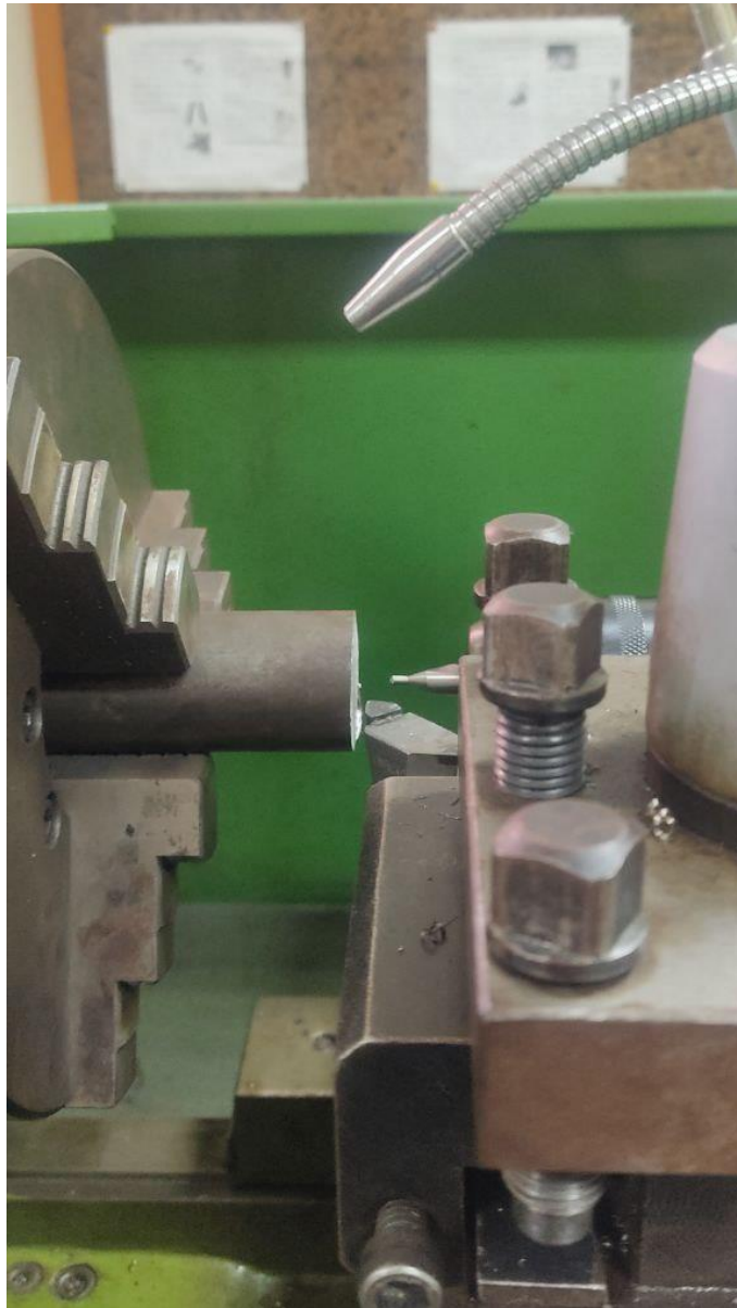
Figura 56: Configuración en el Torno para Refrentado y Perforado. Fuente: Fernández (2022).
