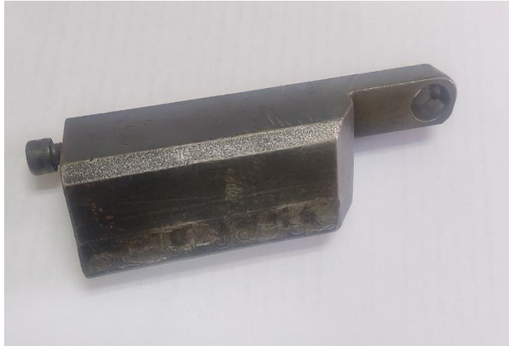
Figura 44: Portaherramientas Impero para Cuchillas Orientables.
