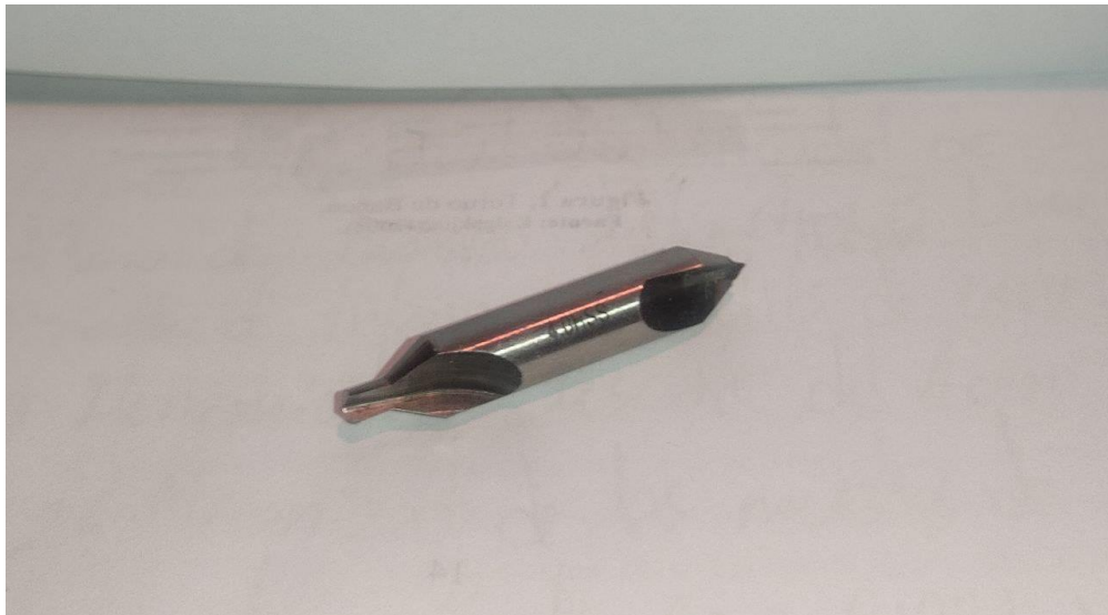
Figura 58: Mecha de Centro de 4 mm, HSS; tras Fractura de una Punta. Fuente: Fernández (2022).
