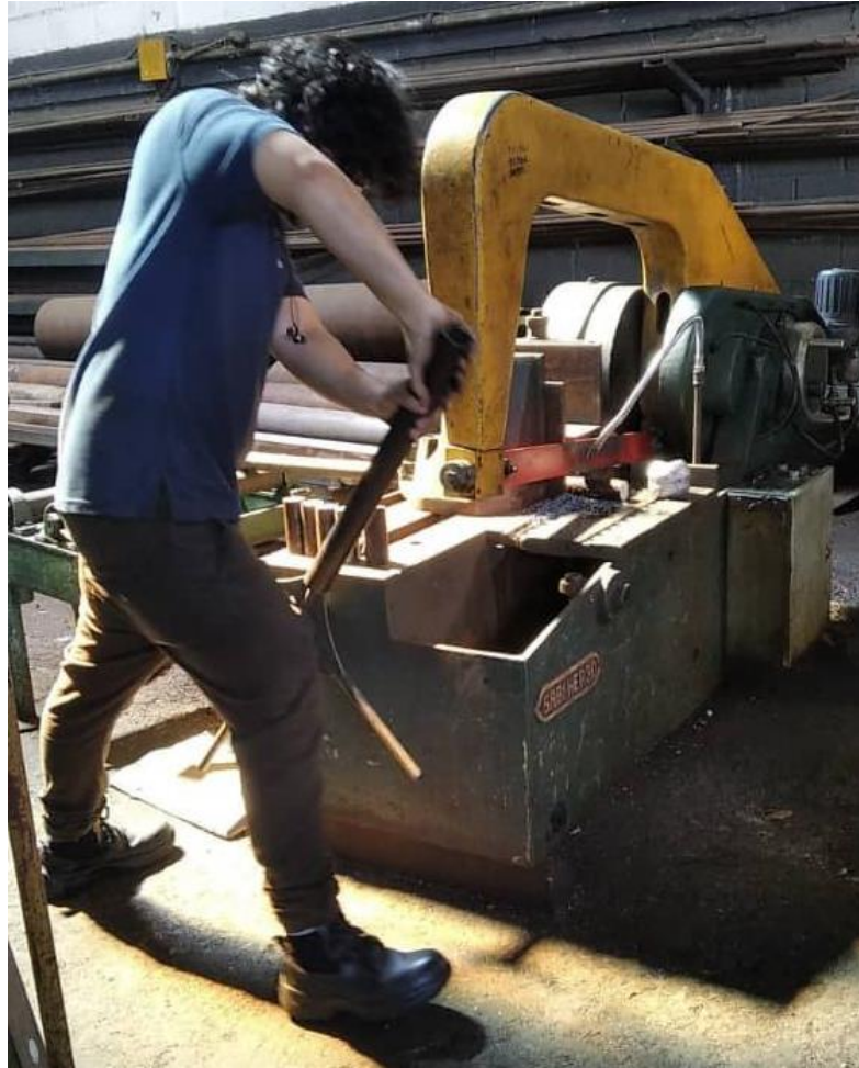
Figura 54: Proceso de Corte con Sierra de las Probetas. Fuente: Fernández (2022).
