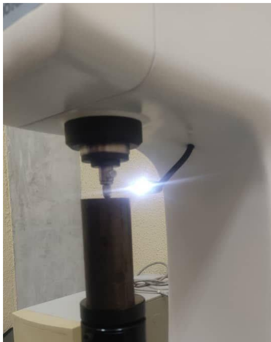
Figura 37: Segunda Probeta de Dureza, Refrentada. Fuente: Fernández (2022).
