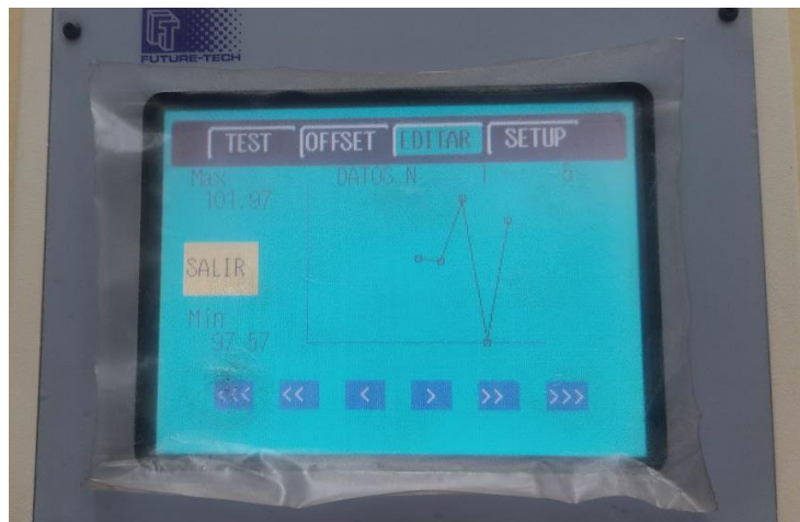
Figura 35: Gráfico de los resultados de las mediciones de dureza en la longitud de la probeta cilindrada. Fuente: Fernández (2022).
