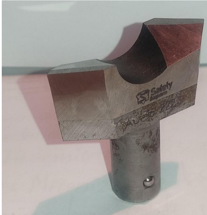
Figura 49: Cuchilla Orientable de Acero Rápido, Modelo AC-16 222 S, Utilizada.
