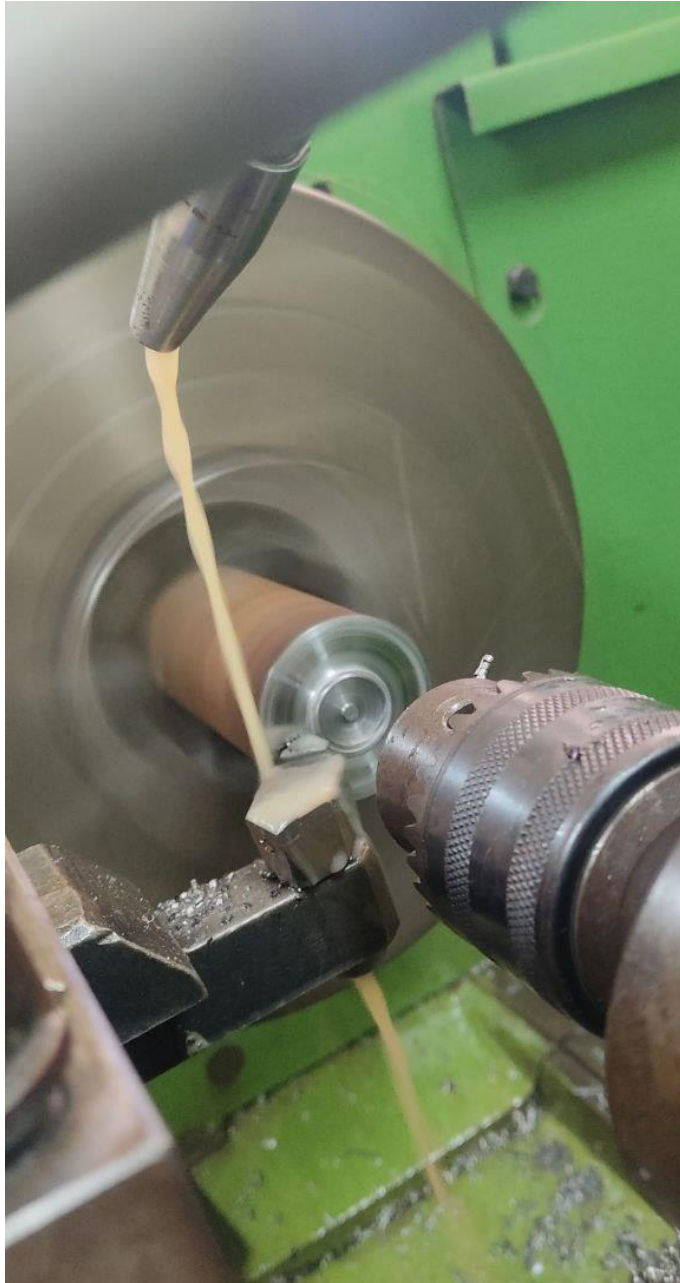
Figura 57: Ejecución del Refrentado. Fuente: Fernández (2022).
