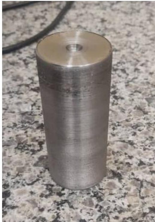
Figura 33: Primera Probeta de Dureza, Cilindrada.
