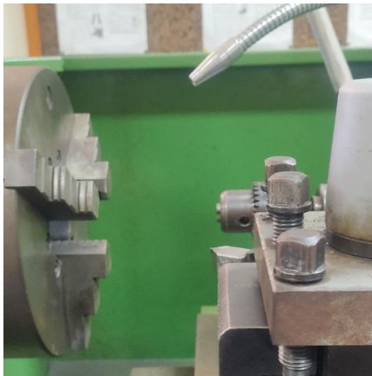
Figura 48: Configuración de las Herramientas de Corte, con el Mandril.
