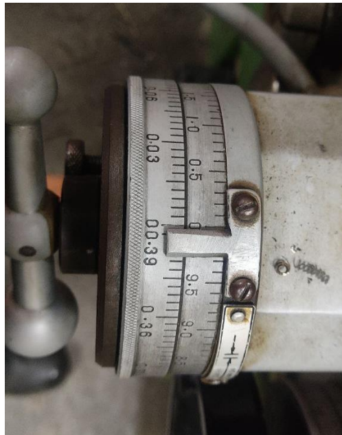
Figura 52: Escala en Manivela del Carro Transversal.
