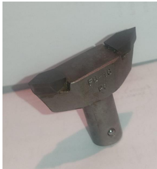
Figura 46: Cuchilla Orientable FB 16-P6 Utilizada en los Ensayos.
