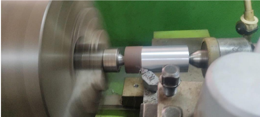
Figura 62: Ejecución del Cilindrado. Fuente: Fernández (2022).
