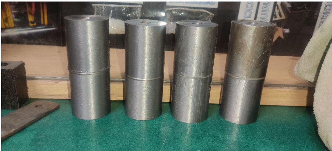
Figura 68: Probetas Ensayadas y Lubricadas para su Preservación. Fuente: Fernández (2022).
