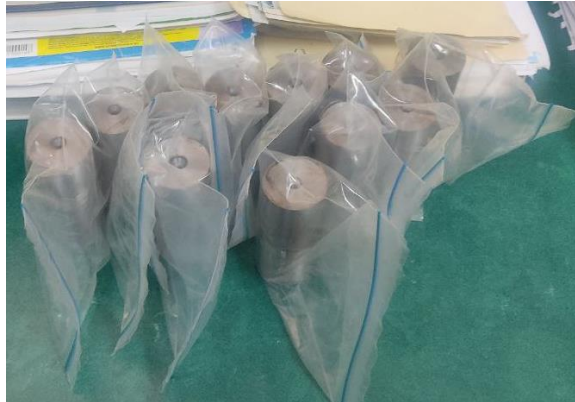
Figura 69: Probetas Ensayadas, Lubricadas y Almacenadas Herméticamente.
