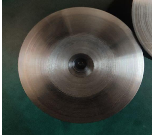
Figura 30: Vista Transversal de la Geometría de las Probetas, 41 mm de diámetro.
