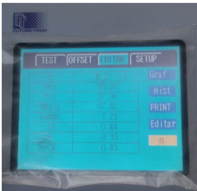
Figura 40: Análisis estadístico de los resultados de la medición de dureza la probeta refrentada. Fuente: Fernández (2022).
