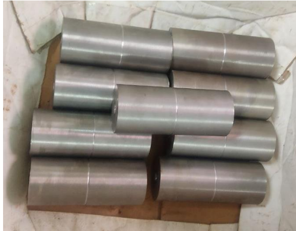
Figura 64: Conjunto de Probetas Cilindradas con Línea Divisoria. Fuente: Fernández (2022).
