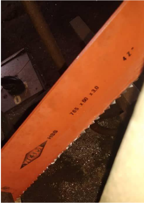
Figura 43: Hoja de Sierra de HSS utilizada en la Sierra de Vaivén. Fuente: Fernández (2022).
