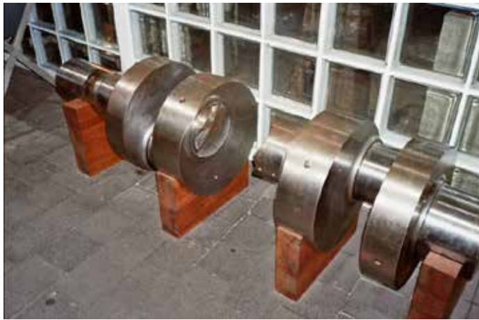
Figura 7. Cigüeñal Fracturado Consecuencia de la Fatiga
