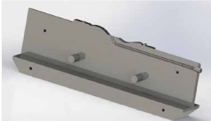
Figura 66. Diseño en SolidWorks de Hembra Nro1 del molde monocasco para el chasis de FC
