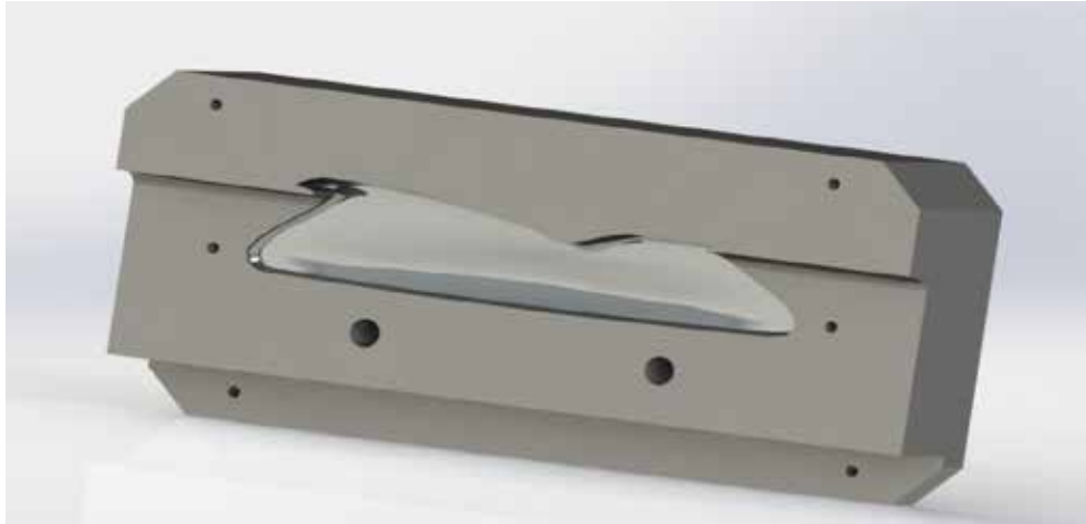
Figura 62. Hembra Nro1 del molde monocasco para el chasis de FC Fuente: De La Hoz (2021)
