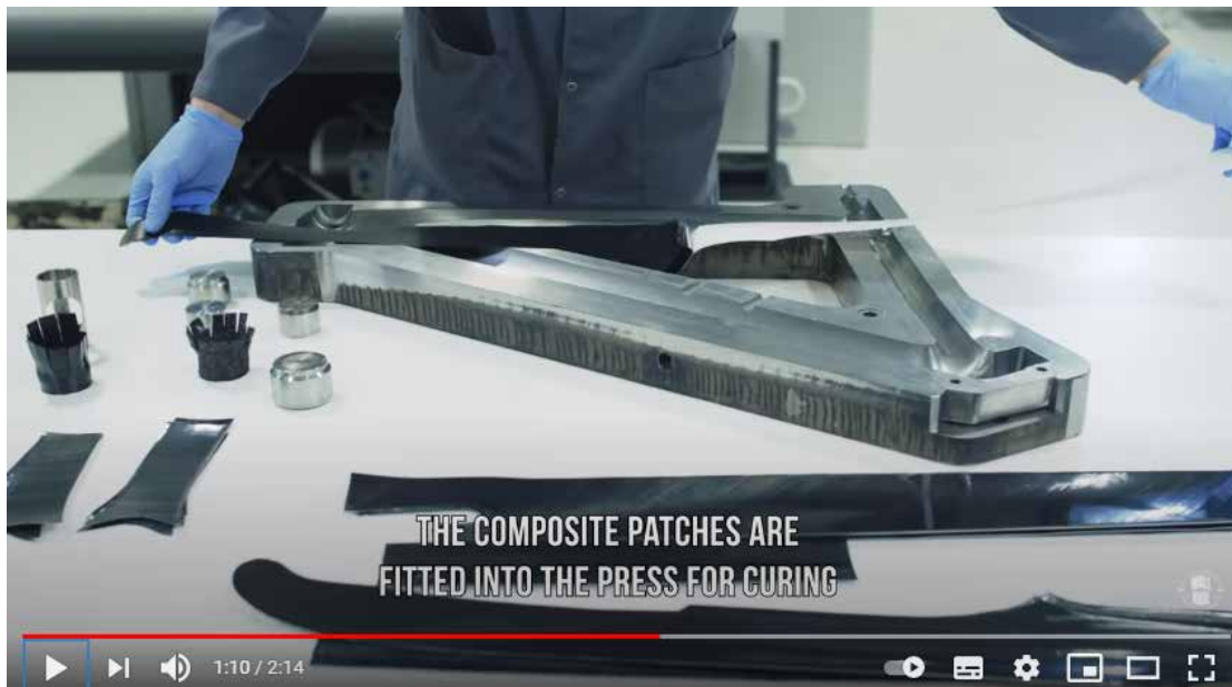
Figura 59. Molde monocasco de acero para cuadro de bicicleta en fibra de carbono Fuente: https://www.youtube.com/watch?v=SVi_RFco2-4&t=70s .
