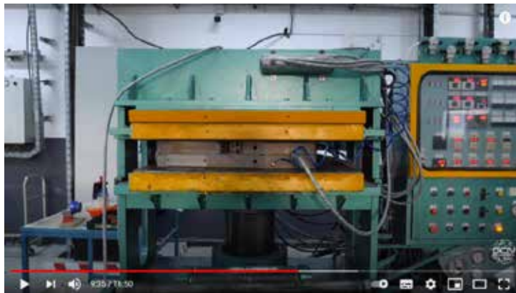
Figura 68. Molde montado en la prensa de la fábrica de bicicletas LOOK Fuente: https://www.youtube.com/watch?v=pk-0XV1Ro8o&t=556s
