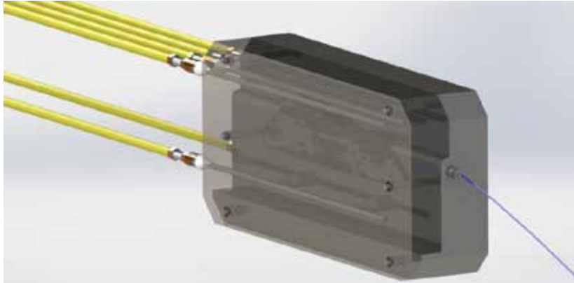
Figura 75 Vista final de molde monocasco armado
