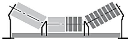
Figura 23: Estaciones con rodillos de una banda transportadora. Fuente: RULMECA (2010)
