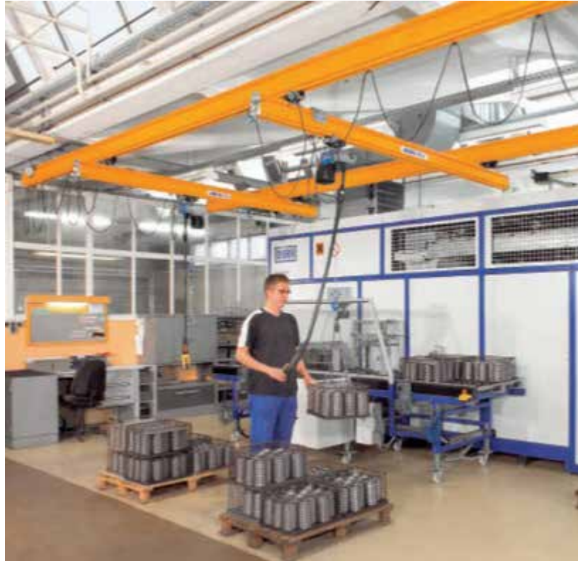
Figura 37: Posible solución 1. Polipasto sobre puente grúa
