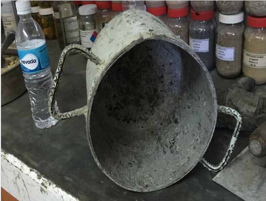
Figura 7.: Recipiente usado para los pesos unitarios. Fuente: Izquierdo, Ruiz (2018).
