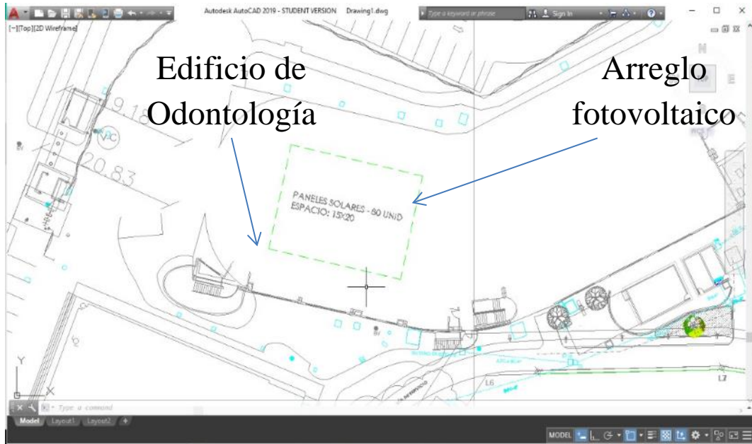
Imagen 11. Sistema fotovoltaico sobre el techo del edificio de odontología
