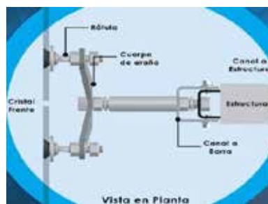
Figura 10: Vista en Planta
