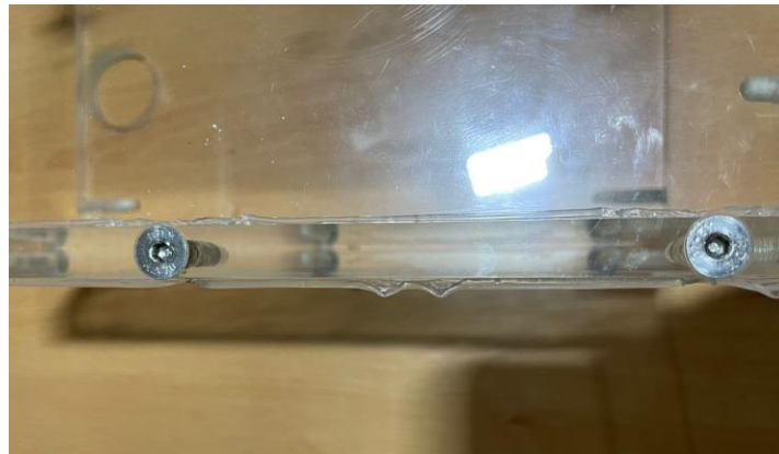
Figura 15. Silicona aplicada en las uniones de las láminas de acrílico.
