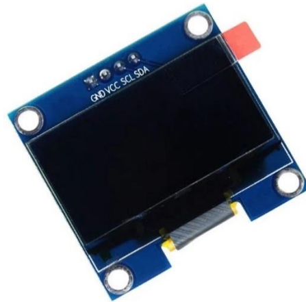
Figura 25. Pantalla oled SSD1306.
