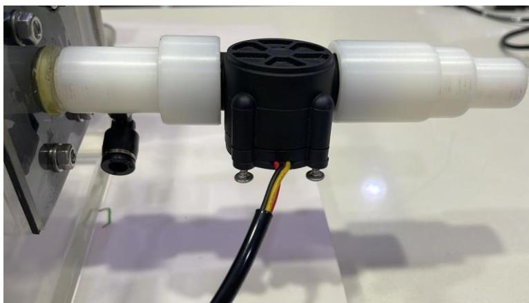
Figura 38. Sensor de flujo y piezas de acople colocadas.
