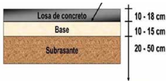
Figura 13: Corte transversal de un pavimento rígido
