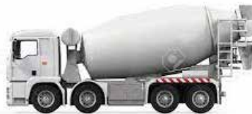
Figura 19: camión mezclador o Mixer.
