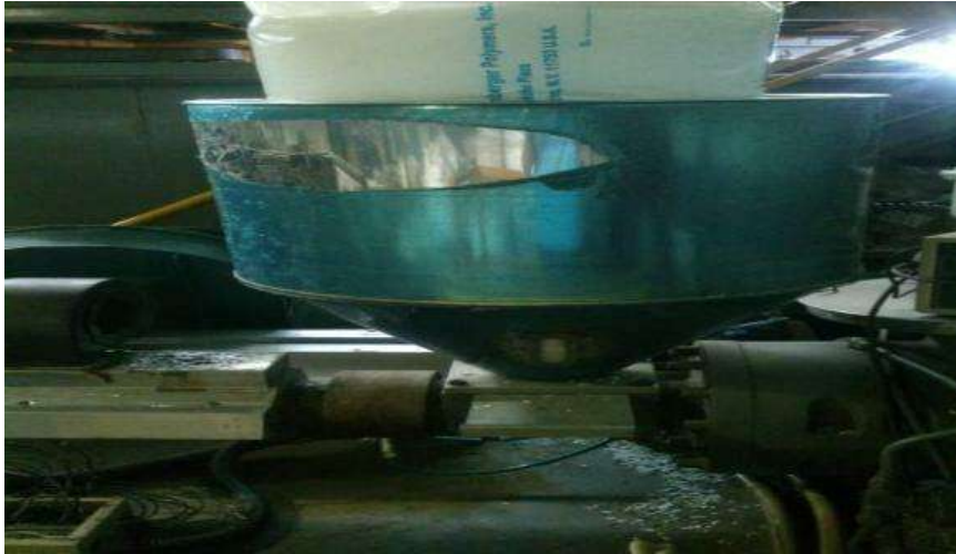
Figura 12: Tolva Receptora del material
