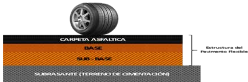
Figura . Estructura del Pavimento Flexible
