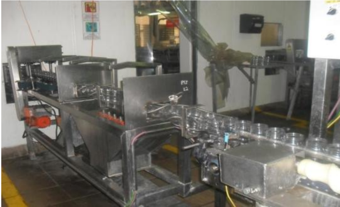
Figura 49: El empuje se crea para mover los envases en el higienizador (Imagen real) Fuente: Velásquez C. (2.020)
