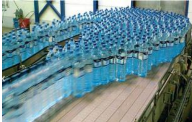
Figura 18: Representación de un sistema de bandas modulares para acumulamiento de envases.
