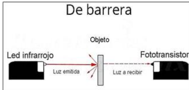
Figura 28: Sensor óptico (fotoeléctrico) de tipo barrera. Fuente: Mecafenix, F. (2.018)
