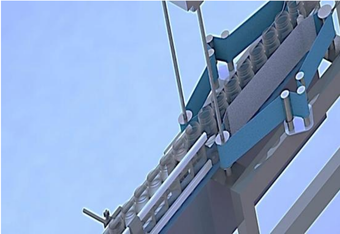
Figura 48: Punto de contacto envase-correas laterales para producir empuje. Fuente: Velásquez C. (2.020)
