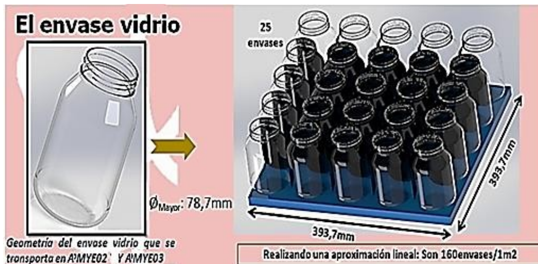
Figura 45: Modelado del número de envases de vidrio sobre un área específica. Fuente: Velásquez C. (2.020)
