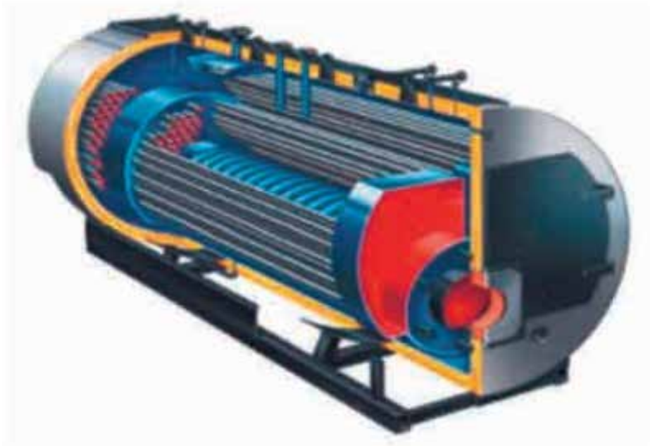
Figura 4. Detalle de caldera pirotubular Fuente: Martínez, J. (2013)
