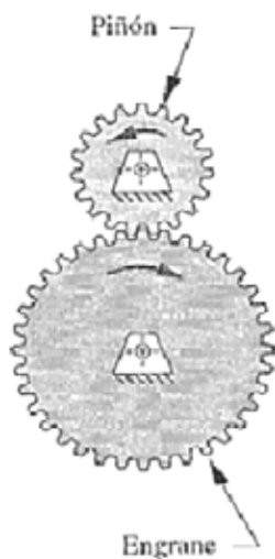
Figura: 12. “Engranaje externo” Fuente: Tassoni D. (2.007).
