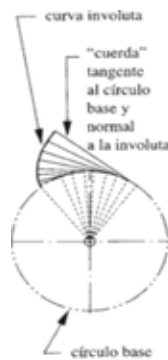
Figura: 12. “Desarrollo de la involuta de un círculo”
