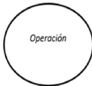
Figura 3. Símbolo de operación para la realización del diagrama de proceso Fuente: Ingeniería Online (2020)
