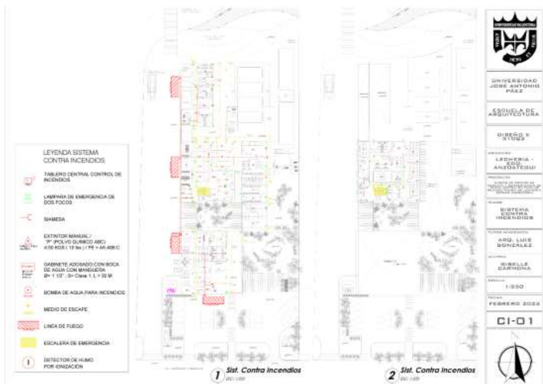
Figura 29. Sistema Contra Incendio. Centro de Rescate y Conservación de Fauna Marina. Fuente: la Autora (2023).
