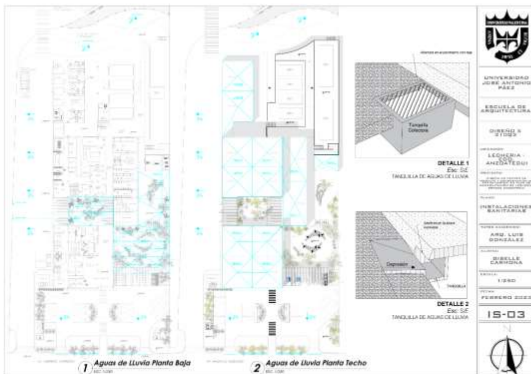
Figura 27. Instalaciones Sanitarias. Plano de Aguas de Lluvia. Centro de Rescate y Conservación de Fauna Marina. Fuente: la Autora (2023).
