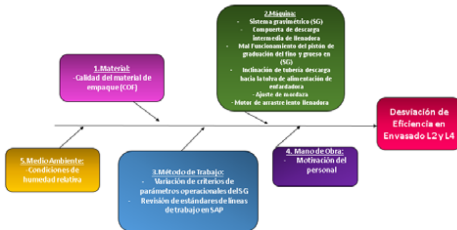
Figura N° 14: Desviaciones en eficiencia líneas 2 y 4
