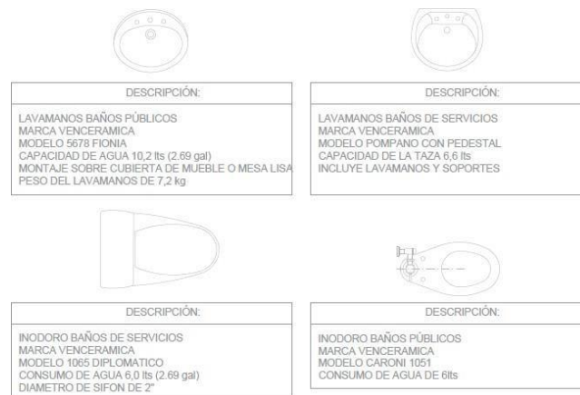
Figura 24. Detalle de piezas sanitarias de servicio instalaciones sanitarias Fuente: La Autora (2022)
