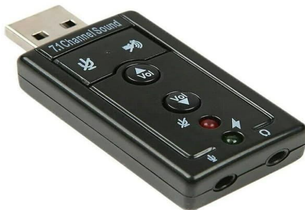
Figura 5. Tarjeta de Sonido 7.1 USB 2.0 Tipo Pendrive. Fuente: SOSElectronic.
