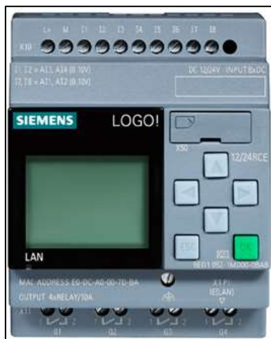
Figura 39: Programador Lógico de Control “LOGO 8!” Fuente: Pagina web de Siemens.
