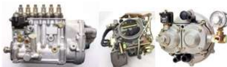
Figura3: Reguladores de motores de combustión diesel, gasolina y a gas. Fuente: imágenes de reguladores de combustible de internet.
