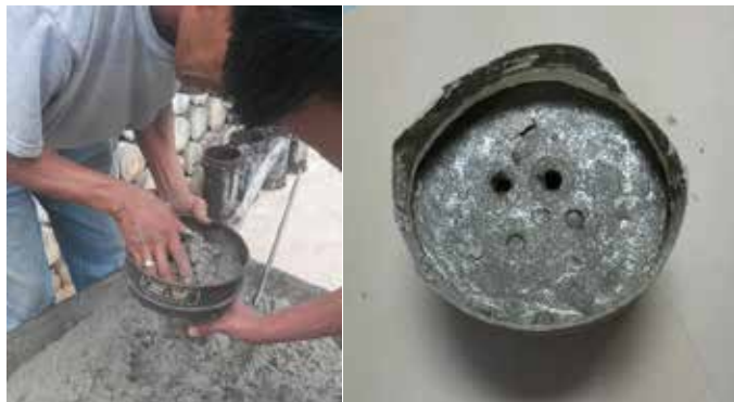
Anexo 12: Ensayo de Fraguado realizado con el Penetrómetro a la Mezcla de Concreto Base
