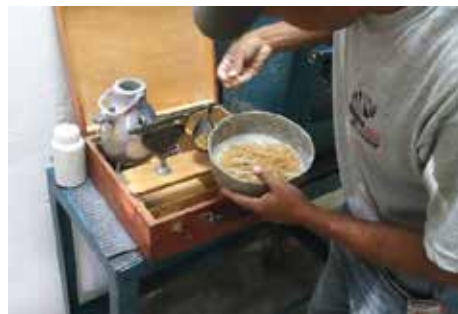
Anexo 7: Ensayo de Granulométrico de la Arena lavada utilizada para la mezcla de concreto
