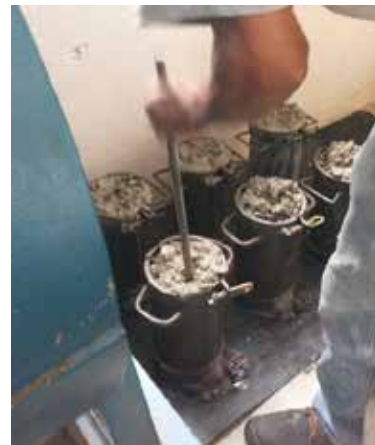
Anexo 9: Colocación de las mezclas de concreto en los moldes cilíndricos
