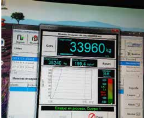
Anexo 14: Ejemplos de cargas de ruptura y tipo de fallas arrojadas por el ensayo a compresión de los cilindros de concreto
