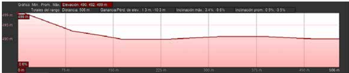
Figura 37: Perfil longitudinal de la Av.4 del sector Ciudad Jardín Mañongo.
