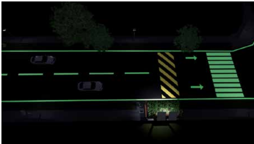
Figura 39: Demarcación final (Pintura fotoluminiscente) 1.
