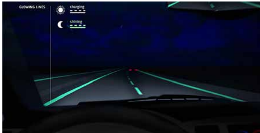
Figura 100: Demarcación con pintura fotoluminiscente.
