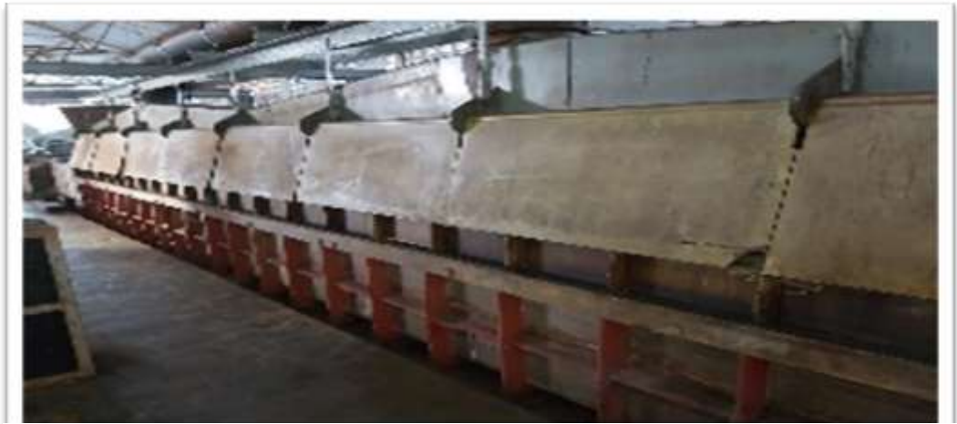
Figura n°11 y 12. ILUSTRACIÓN DE LA TINA DE ÁCIDO YA CULMINADO EL ENHEBRADO EN TREXA C.A
