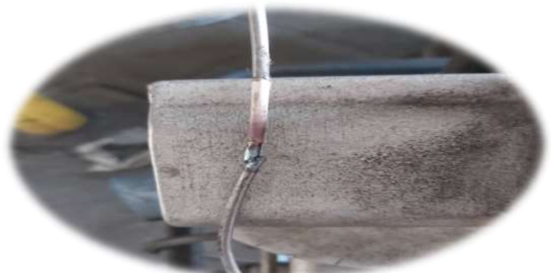
Figura N°31. ILUSTRACIÓN DE LA FALLAS DE SOLDADURAS DEL ALAMBRE CAUSANDO NO CONFORME O DESPERDICIOS, EN TREXA C.A
