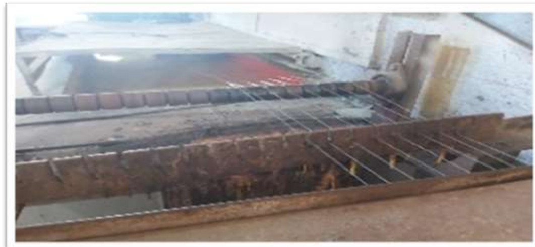
Figura N°16 y 17. ILUSTRACIÓN DE INMERSIÓN EN LA TINA DE ZINC Y LUEGO PIEDRA, EN TREXA C.A
