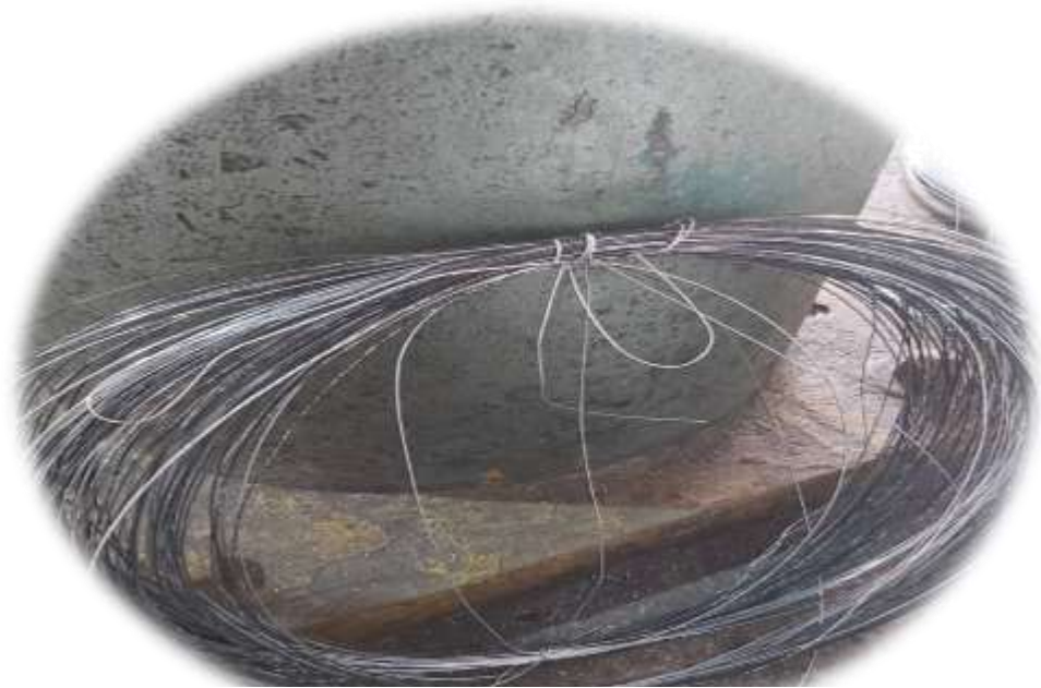
Figura N°29 y 30. ILUSTRACIÓN DEL ALAMBRE NO CONFORME O DESPERDICIOS POR ENREDOS Y RUPTURAS, EN TREXA C.A
