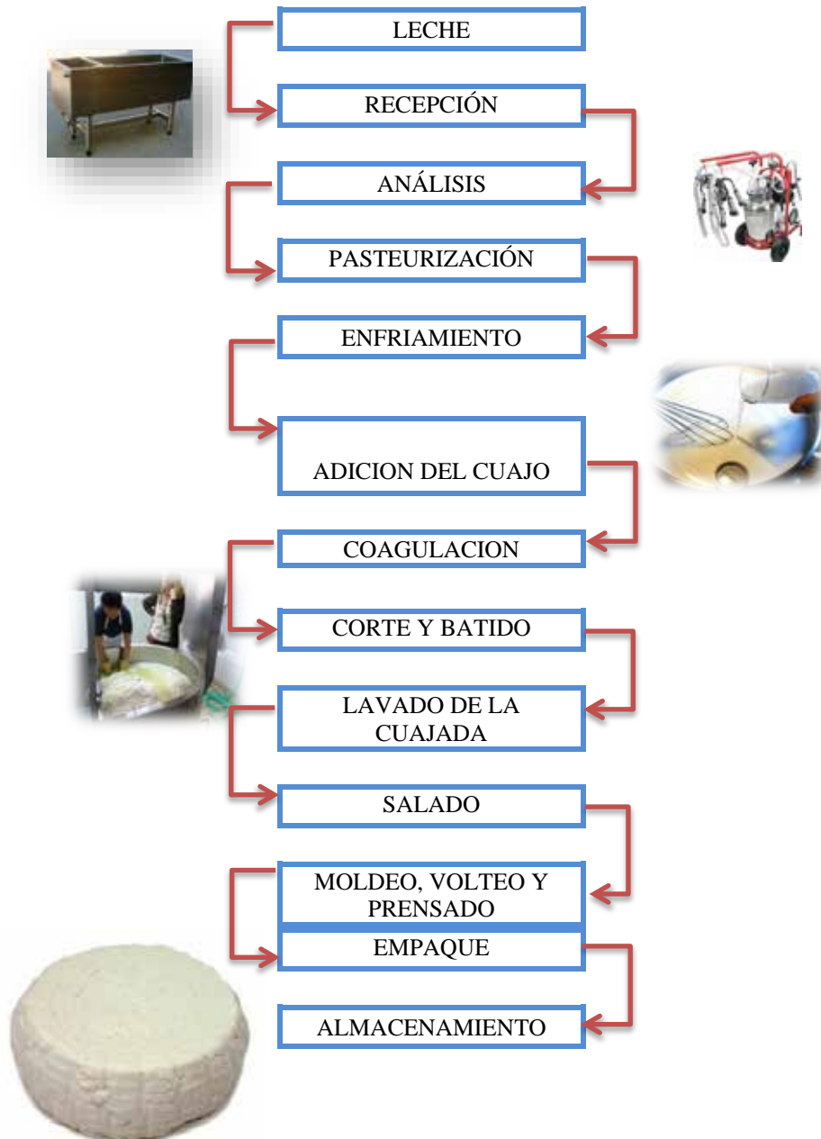
Figura 4. Diagrama de flujo del proceso de elaboración del queso Fuente: Graterol, C. (2018)
