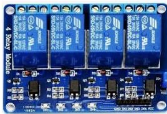
Figura 49. Módulo de relevadores
