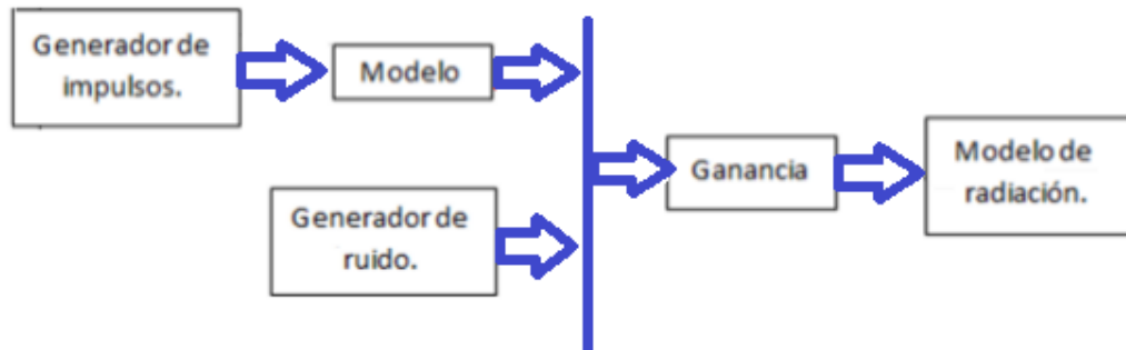
Figura 4. Diagrama de generación de la señal acústica Fuente: Izquierdo, M y Maldonado, A (2019).
