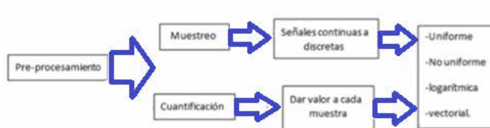
Figura 7. Diagrama de la digitalización de la señal de voz
