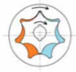
Figura 11. Corte transversal de una bomba geromotor.
