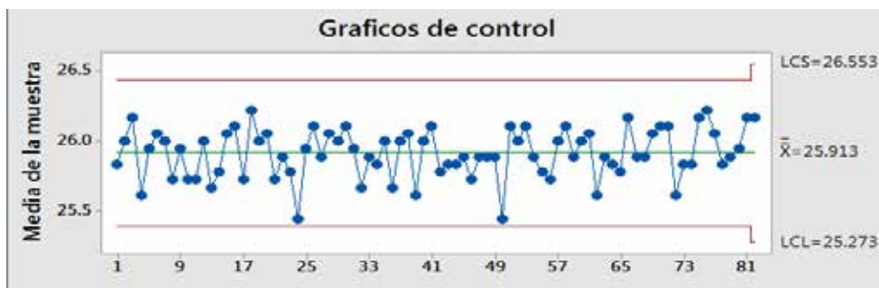
Gráfico 4: Gráfico de control de la capacidad de número de cerdas/orificio.
