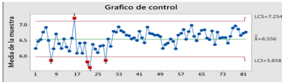
Gráfico 2: Gráfico de control de la capacidad del proceso de retención. Fuente: Barazarte K, Hurtado J (2017)
