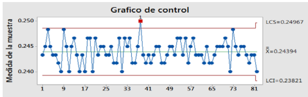
Gráfico 14: Gráfico de control de la capacidad del proceso de espesor del alambre. Fuente: Barazarte K, Hurtado J (2017).
