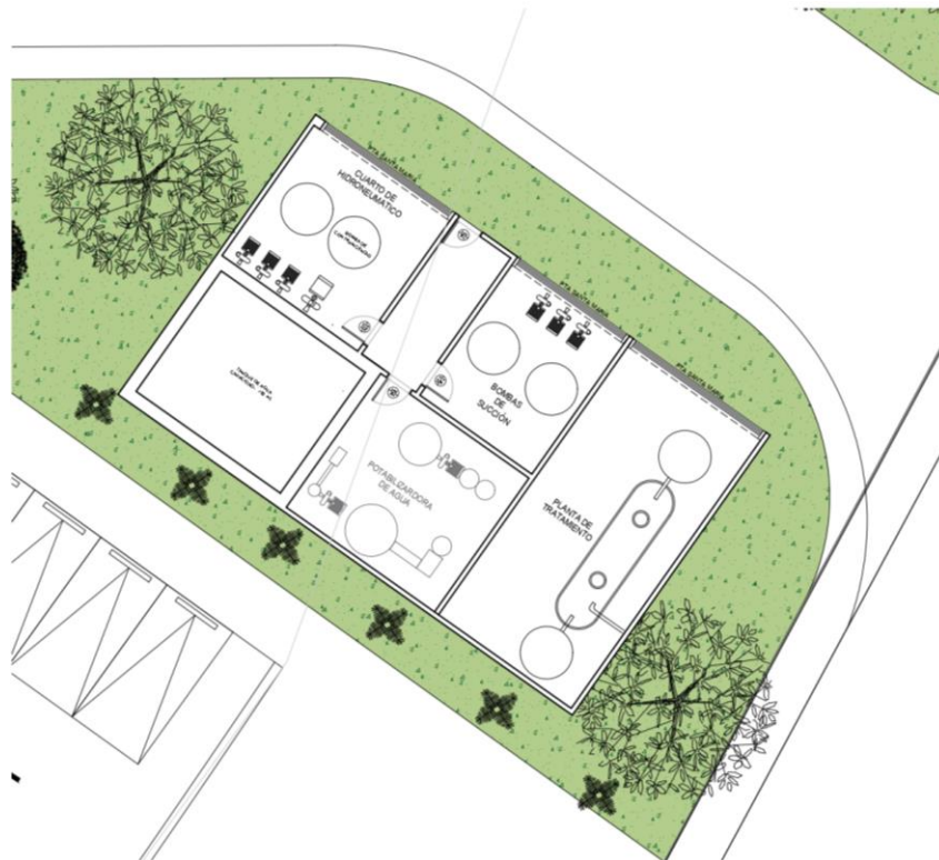
Figura 52. Instalaciones Sanitarias. Fuente: La Autora (2022).
