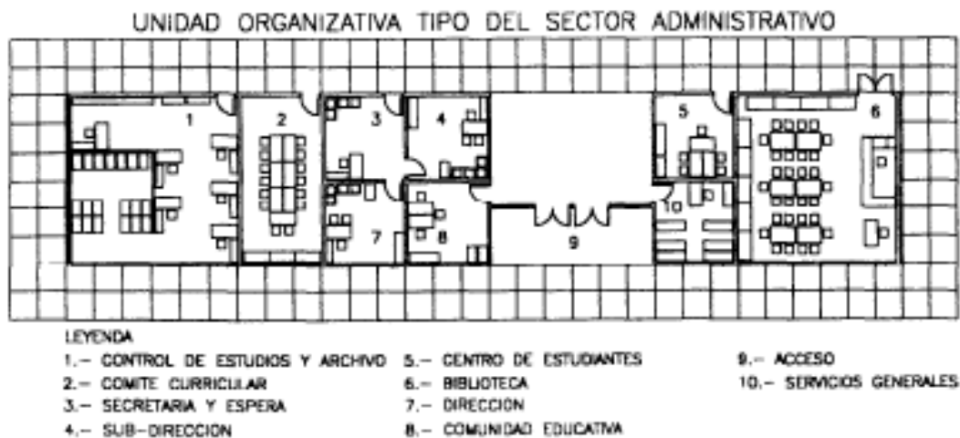
Figura 16 Área Administrativa y Biblioteca, Fuente: Normas y estándares para las construcciones escolares - UNESDOC
