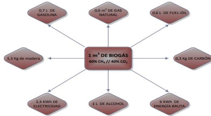
Figura 10: Esquema valor energético de un biogás estándar respecto a otras fuentes
