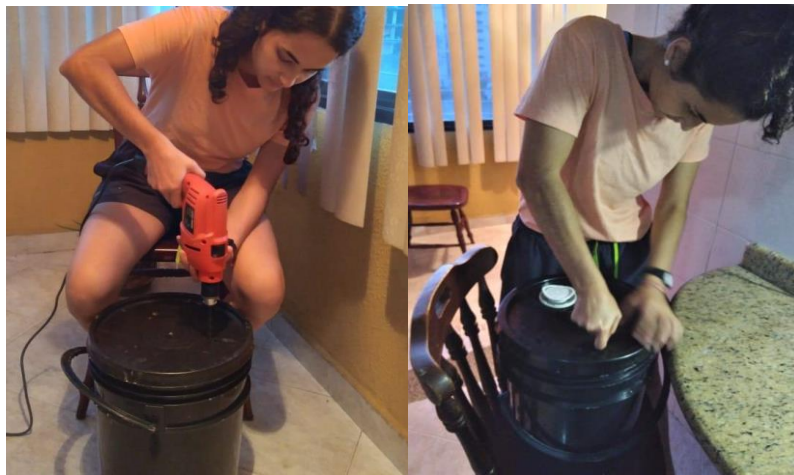
Figura 31: a) Apertura de agujero de suministro. b) Ajuste de la boquilla alimentadora.
