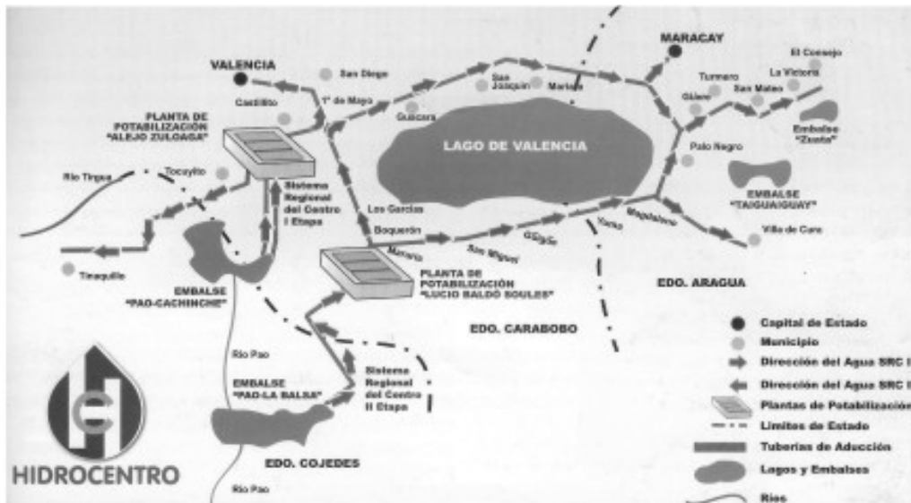
Figura 9: Sistema de distribución de agua
