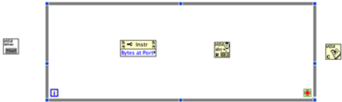
Figura 22. Comunicación Arduino- LabView (paso #3). Fuente: Aguirre, Ferrer (2019)
