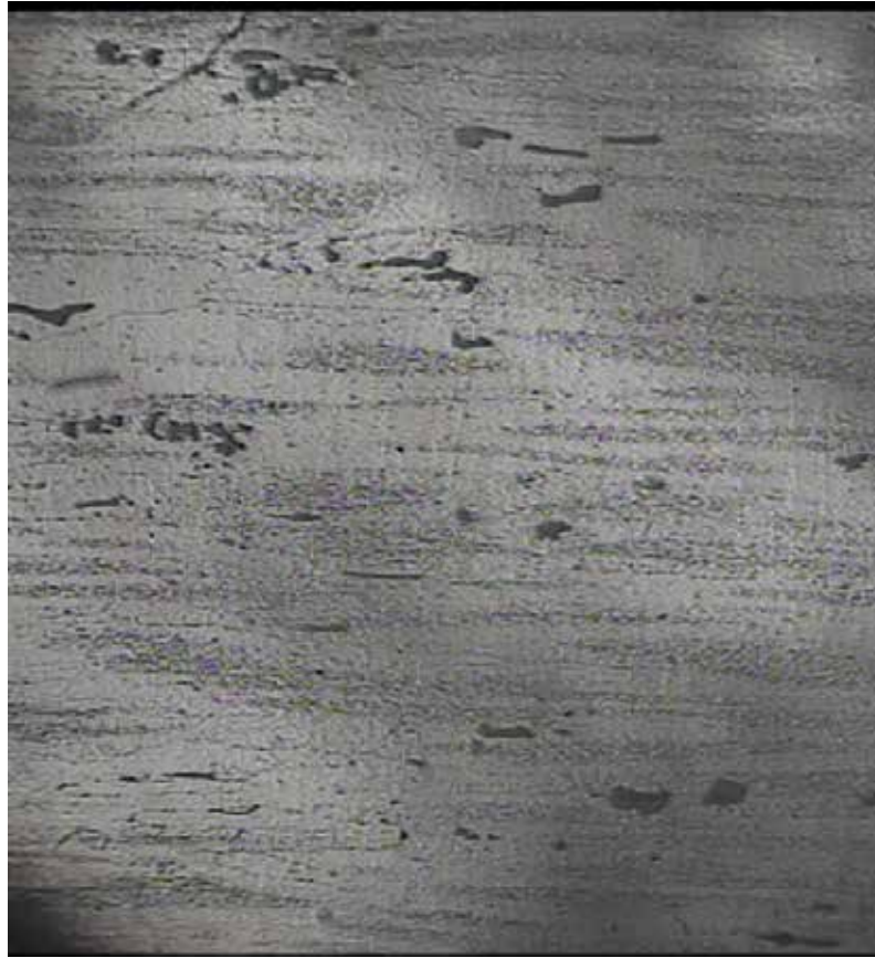
Figura 31. Microscopía longitudinal del material con un tratamiento térmico. 400X.
