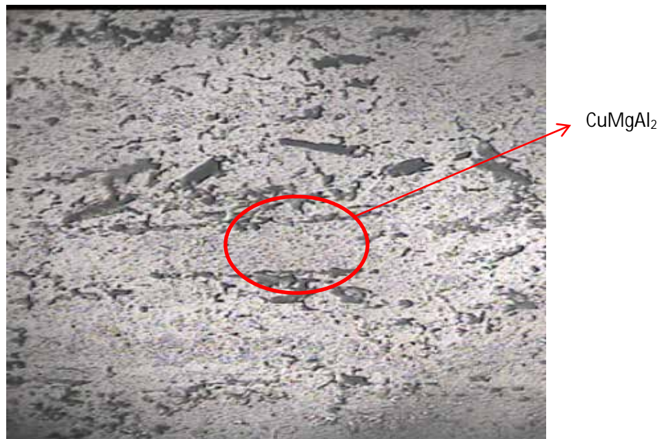
Figura 38. Microscopía longitudinal de la aleación en estudio luego de un recocido 400X.
