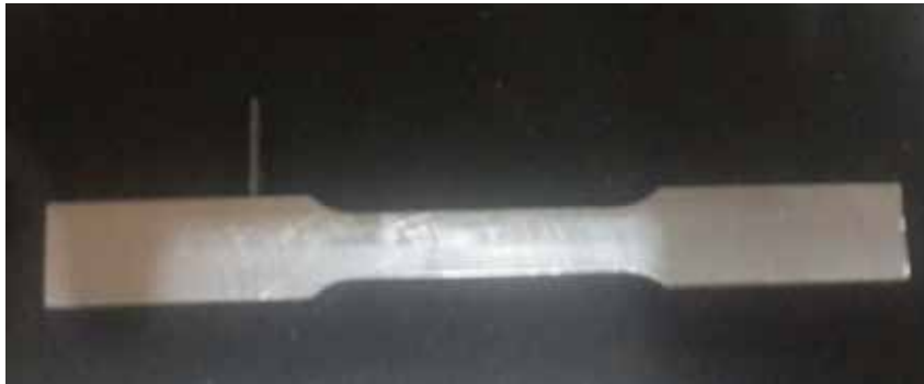
Figura 26. Probeta para ensayo de tracción.
