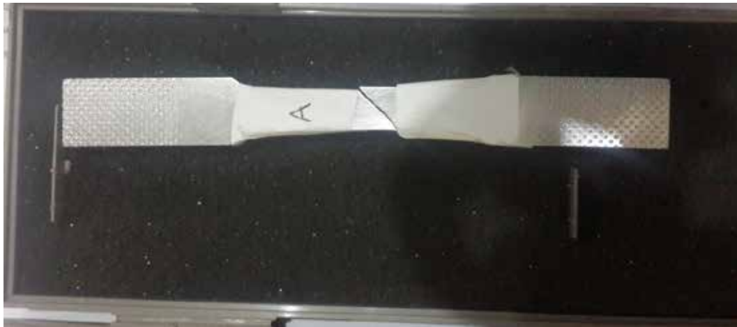
Figura 27. Probeta A, luego del ensayo a tracción
