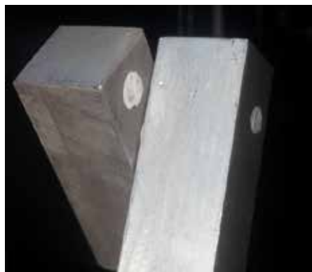
Figura 35. Probetas para análisis metalográfico luego de un recocido.
