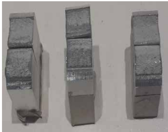
Figura 42. Probetas luego de ensayo Charpy.
