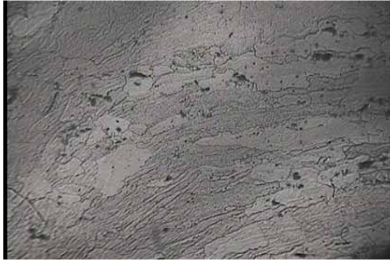
Figura 32. Microscopía transversal del material con un tratamiento térmico y un ataque químico de 20 segundos. 100X.
