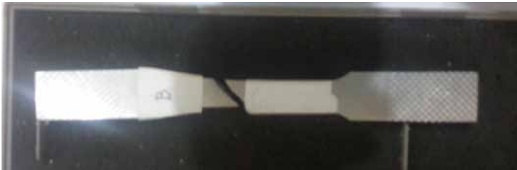
Figura 28. Probeta B, luego del ensayo a tracción
