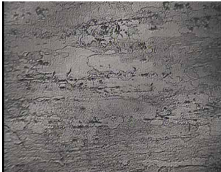
Figura 33. Microscopía transversal del material con un tratamiento térmico y un ataque químico de 30 segundos. 200X.
