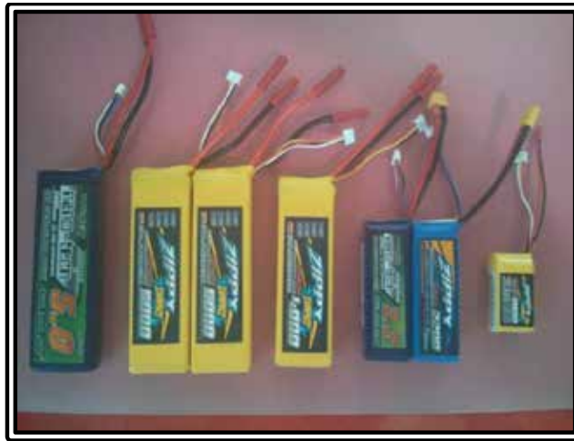
Figura 18: Baterías LiPo. Fuente: www.dedrones.es (2016)
