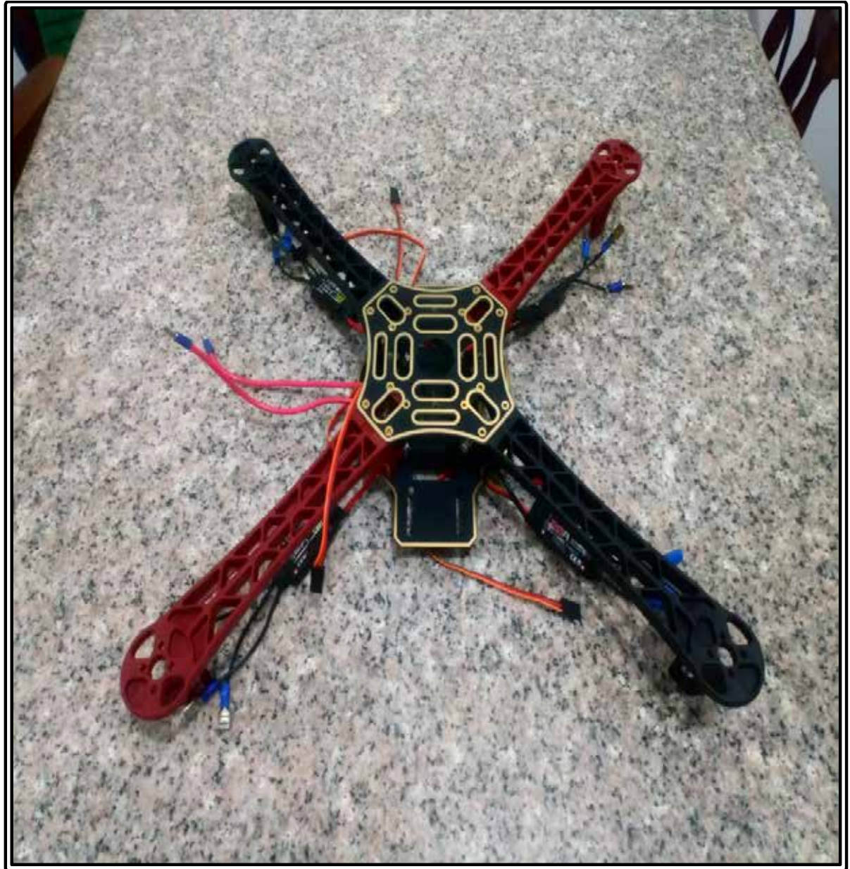
Figura 79: Estructura ensamblada con ESCs Soldados y conectados para el nuevo prototipo.
