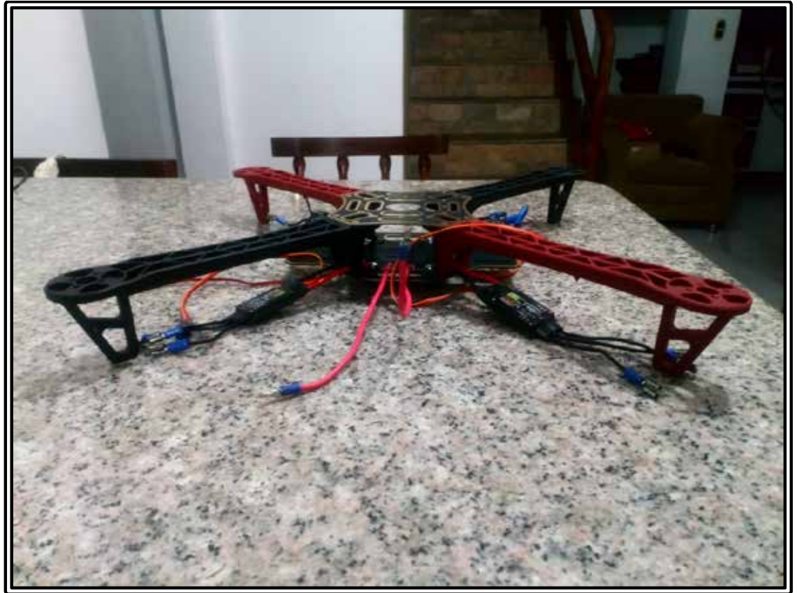
Figura 80: Estructura ensamblada con ESCs Soldados y conectados para el nuevo prototipo.
