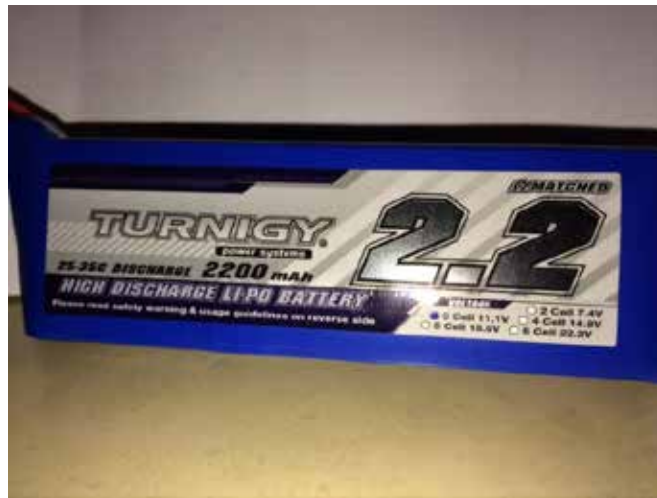
Figura 43: Batería de LiPo Turnigy de 2.2 A
