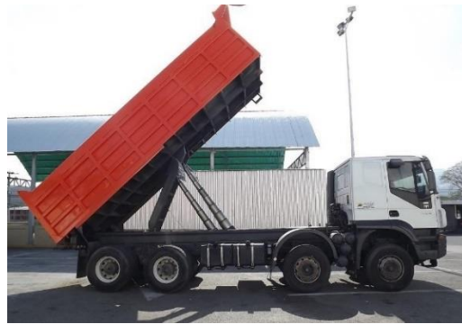
Figura 14: Camión de volteo para desechos.
