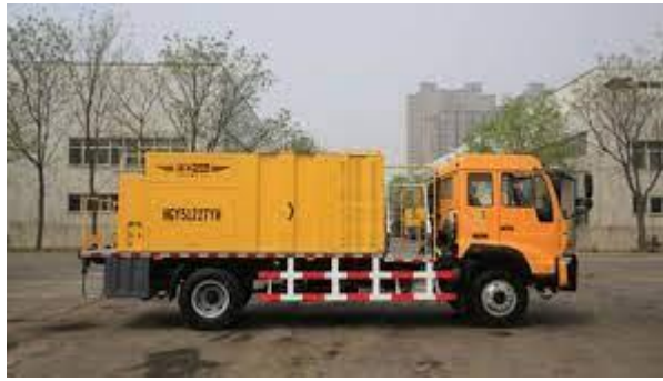
Figura 7: Camión de bacheo.
