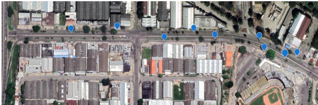
Figura 42: Ubicación de sumidero lateral o de ventana presentes en el tramo II.
