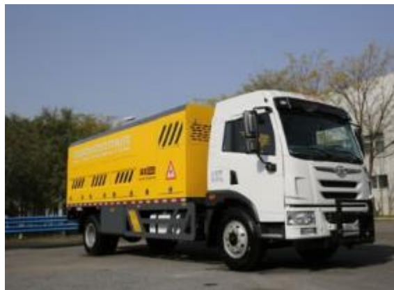
Figura 10: Camión para mantenimiento vial con calentador de asfalto.
