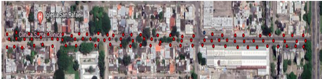
Figura 73: Ubicación de la iluminación vial presente en el tramo I.
