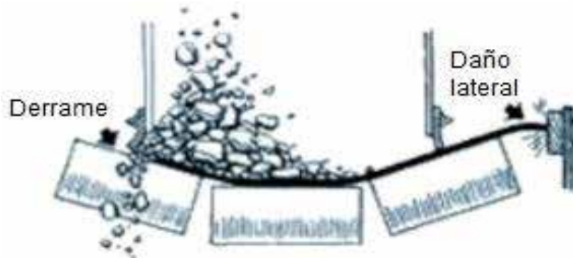
Figura 35: Resultado de mala alimentación en la carga de la cinta.
