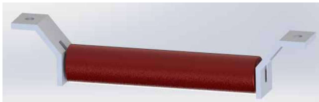
Figura 85: Estación portante inferior Fuente: Badiali, Tami (2020).
