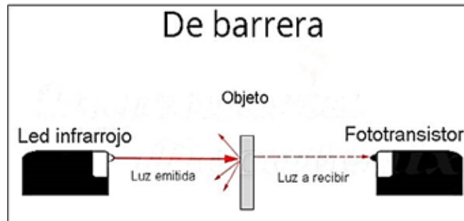
Figura 67: Sensor óptico (fotoeléctrico) de tipo barrera. Fuente: Mecafenix, F. (2.018).
