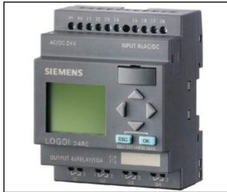
Figura 60: Representación estándar de un PLC nano. Fuente: Mecafenix, F. (2.018)
