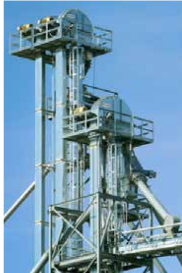
Figura 6: Elevadores de cangilones. Fuente: Brock Grain System (2.015).
