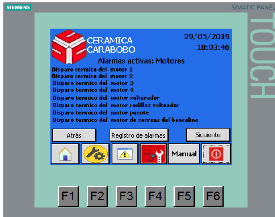
Figura 64 Muestra las alarmas producidas por los motores Fuente: Autor
