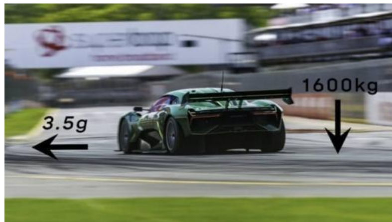
Figura 6. Carga aerodinámica del Brabham BT62 a 300 km/h. Fuente: motor.es/ (2020).
