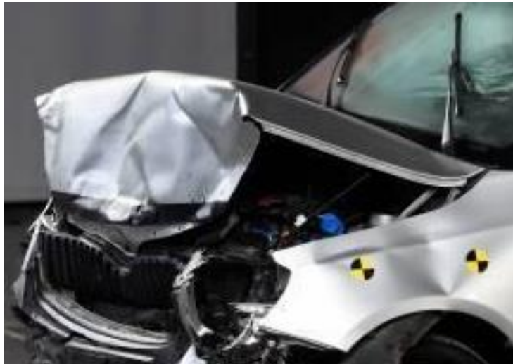
Figura 68. Forma final de un capó luego de un impacto frontal.
