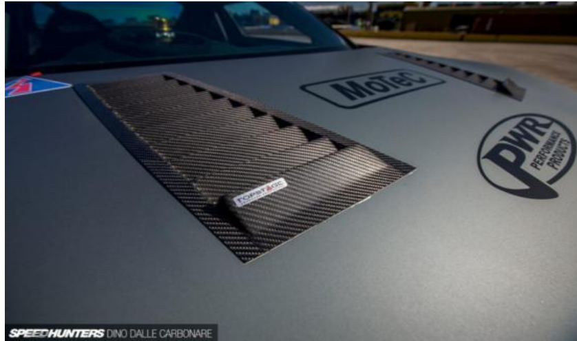
Figura 37. Tomas de aire convencionales hechas en fibra de carbono. Fuente: team-integra.net/ (2006).
