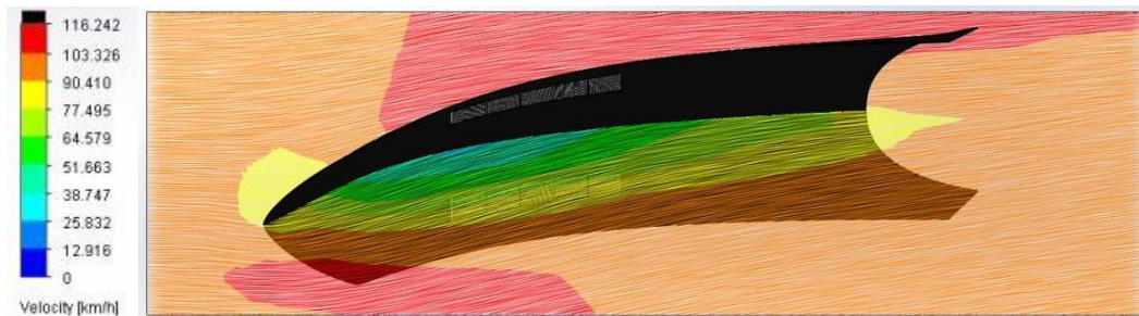
Figura 60. Comportamiento del flujo en el diseño propuesto. Fuente: Jacquin, A (2024).
