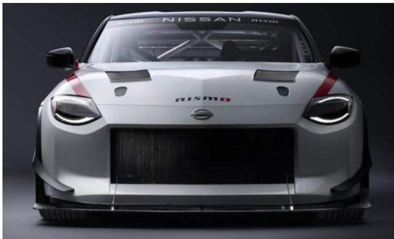
Figura 20. Sistema de ventilación con rejillas de la versión GT4 del Z. Fuente: southernsteamnissanofnewrivervalley.com/ (2022).
