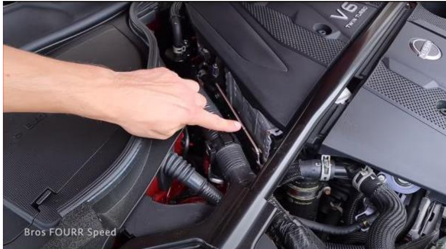
Figura 40. Ubicación de los disipadores de calor del motor VR30DDTT Twin Turbo.
