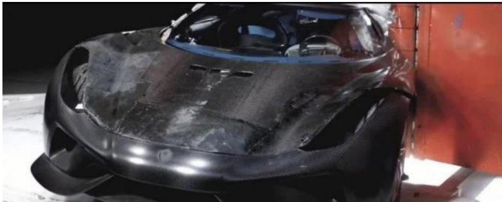
Figura 21. Carrocería del Koenigsegg Regera construida en fibra de carbono.
