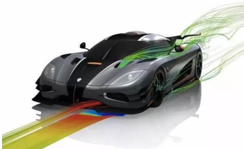
Figura 5. Análisis aerodinámico del Koenigsegg One:1. Fuente: autodinamico.mx/ (2022).
