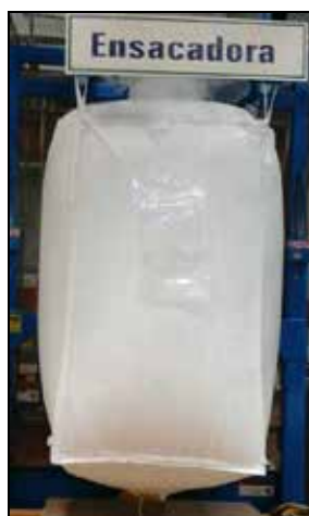
Figura 1. Supersaco de polipropileno. Fuente: Especificación del proveedor (2016).
