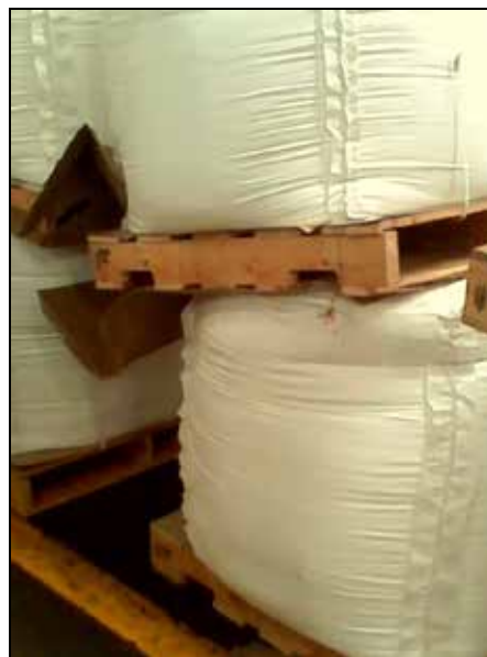
Figura 9: camada de fosfato inestable Autor: Emperador, D. (2017).
